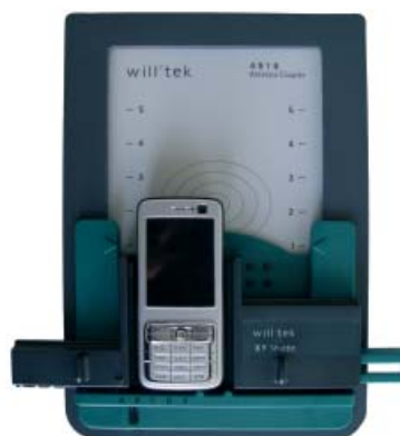
在XY Shuttle上，手机可以固定从右上角直到左下角的25个不同位置。
